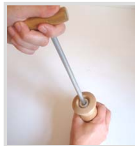
Fertigen Sie eine Vorrichtung um den korrekten Sitz zu prüfen.
