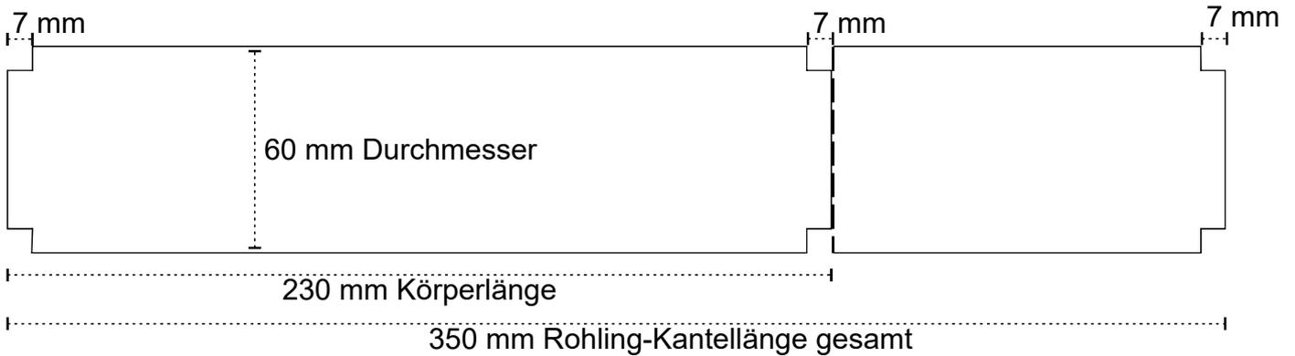
**Vermaßte Skizze zu Bohrdurchmesser und Bohrtiefe, alle Angaben in Millimeter (mm)**
