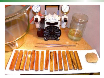
Die Beschwerung und die Pen Blanks mit der Pinzette entnehmen und auf eine Platte, ausgelegt mit Küchenpapier, legen.
