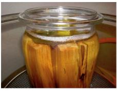
So ist das Glas korrekt gefüllt, die ersten Luftblasen verlassen freiwillig das Holz, noch ohne Vakuum.
