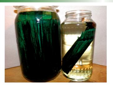
Nachdem die Blanks ein paar Tage getrocknet sind können sie stabilisiert werden. Einen Blank habe ich in ungefärbtes Stabi gegeben, die anderen sind in gefärbtem Stabi untergebracht.
