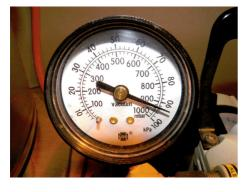
Das Ende ist erreicht, 940 mBar, etwas mehr als nach Herstellerangabe (920 mBar) der Vakuumpumpe erreicht werden kann.
