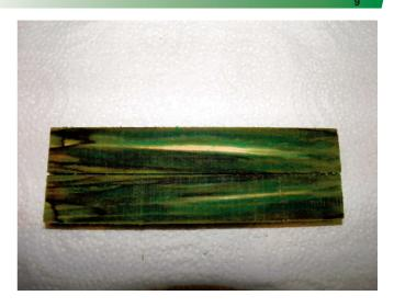
Hier nun der Unterschied. Beide Blanks sind der Länge nach aufgetrennt. Der vollkommen durchgefärbte ist erst gebeizt und dann stabilisiert worden, der andere wurde gleich im gefärbtem Harz stabilisiert.
